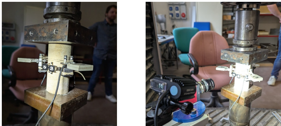
Figure 1 dispositif expérimental mécanique envisagé pour la réalisation de l'essai de compression directe
