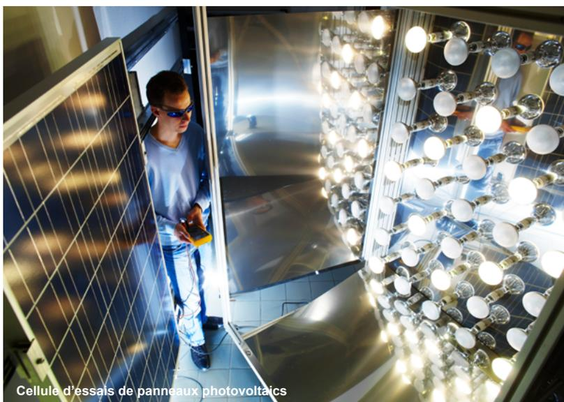
Cellule d'essais de panneaux photovoltaïques
