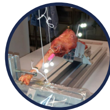
Banc d'essai de laxité ligamentaire sur patte de brebis
