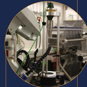
Projet FastMat - Expérience de diffraction des rayons X résolue en temps pendant un essai de fatigue ultrasonique
